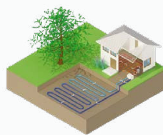
Pompe à chaleur sur capteurs enterrés horizontaux
