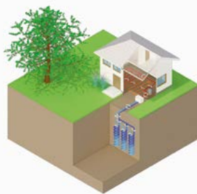
Pompe à chaleur sur corbeilles géothermiques
